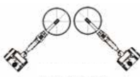
位于管道下方45° 斜角处
