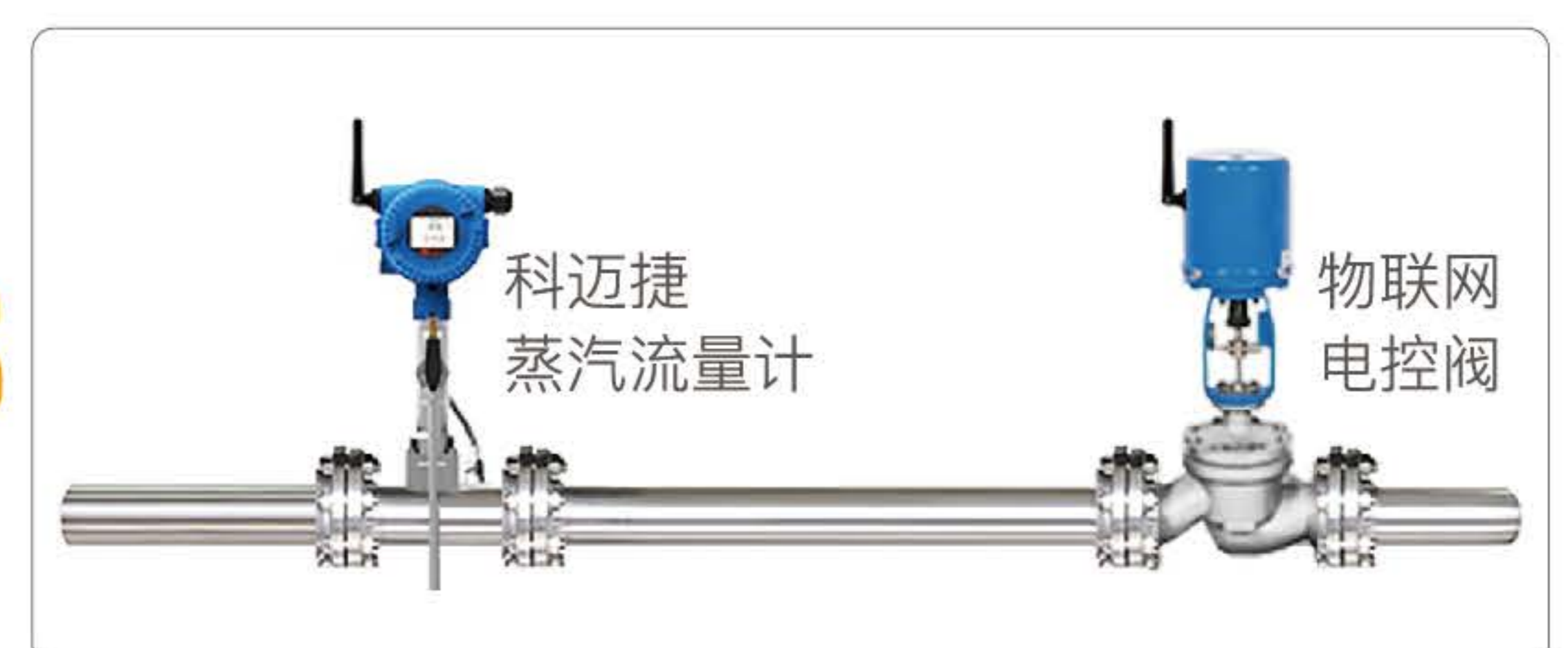
科迈捷温压一体化安装
